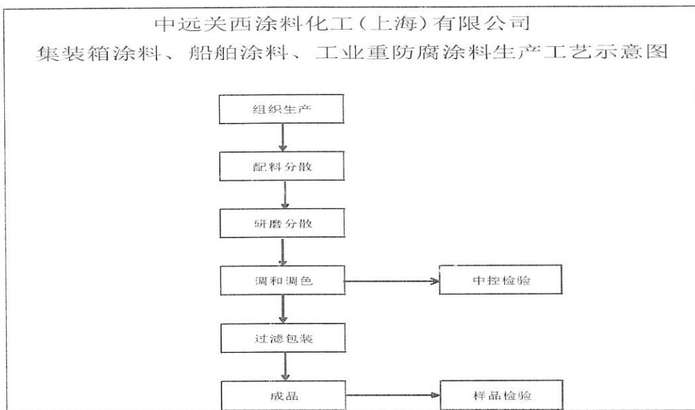
涂料生产流程较简单，为常温常压物理混合过程，无任何化学反应。主要有配料、分散研磨、调合调色、过滤包装过程。
