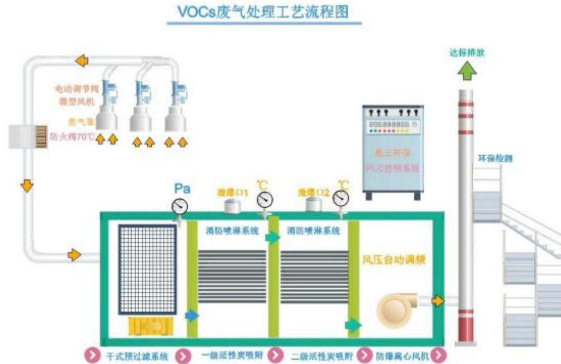
图 6.3.1-2 危废库、清洗 VOCs 废气处理工艺流程图
