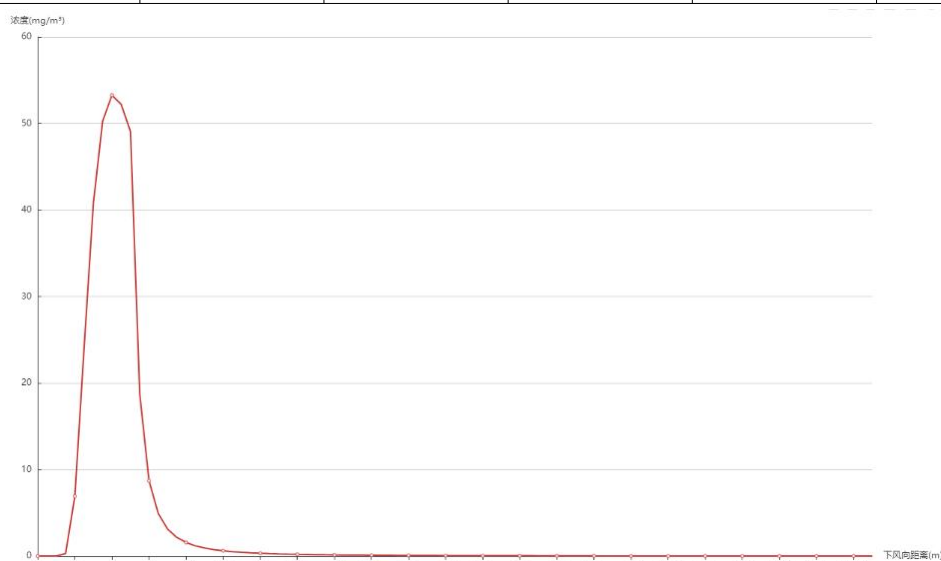
图 4.1-1 最不利气象条件下液氨钢瓶泄漏下风向轴线氨气浓度预测结果图
