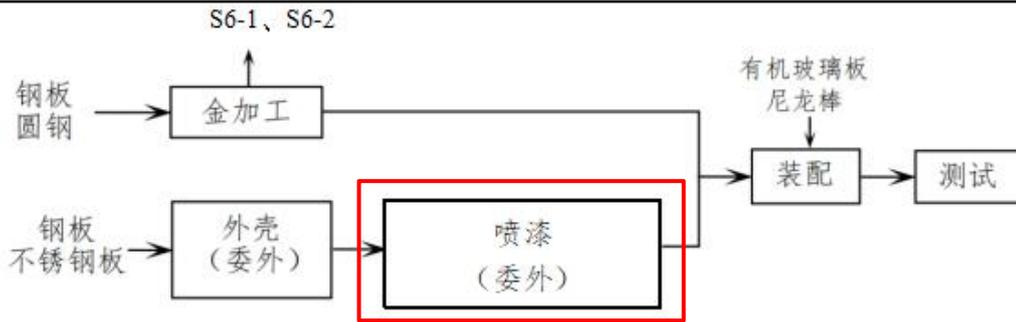
图 2-11 精工机械设备工艺流程图 (实际建设)
