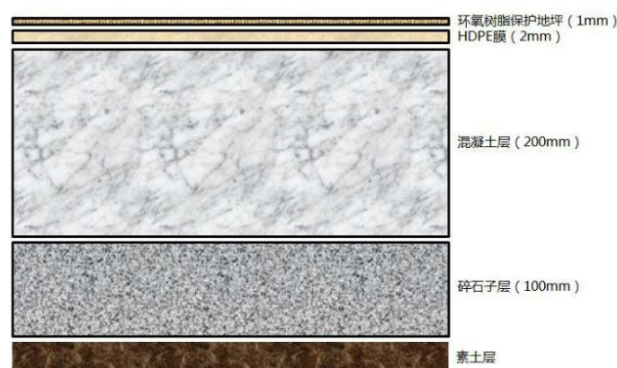
图7.5-2 重点区域防渗层剖面图
