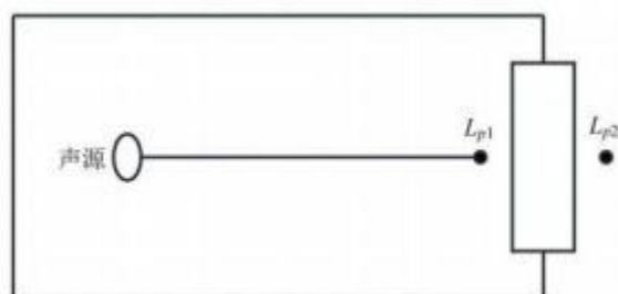
图 4.4-1 室内声源等效为室外声源图例
