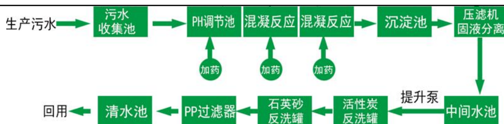
图 4-1 污水站处理流程图
