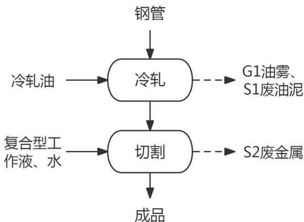
图 2-2 本项目生产工艺流程图
