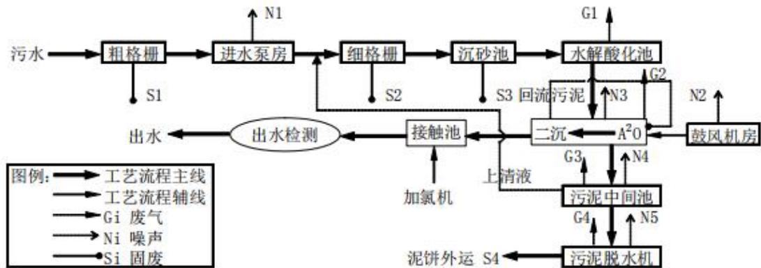
图 4-2 常州东方横山水处理有限公司废水处理工艺流程
