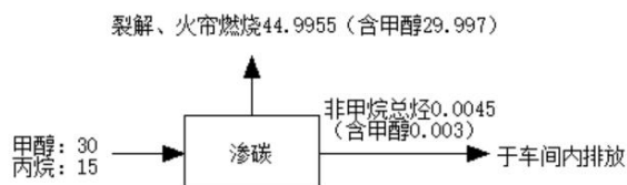
图2-2 本项目非甲烷总烃、甲醇平衡图 (t/a)
