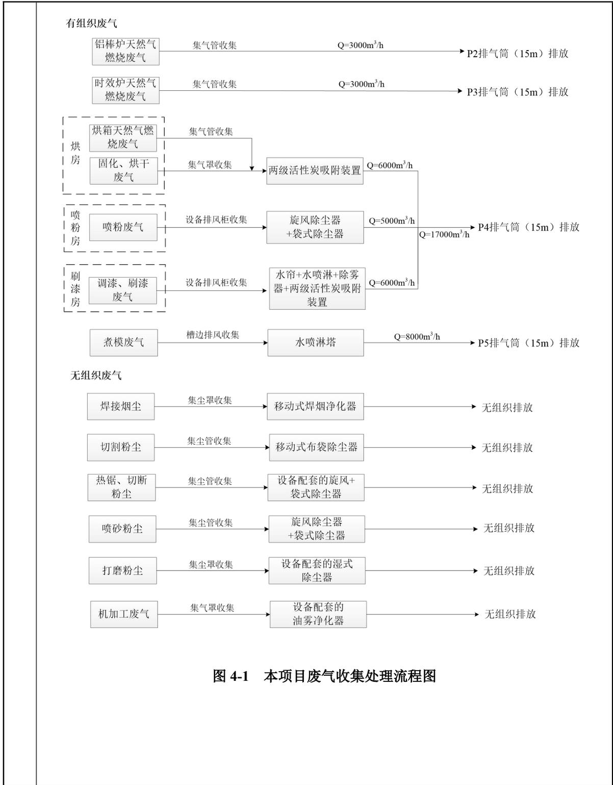
图 4-1 本项目废气收集处理流程图
