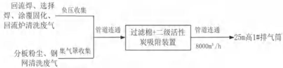
图 4-3 本项目废气收集治理方案示意图
