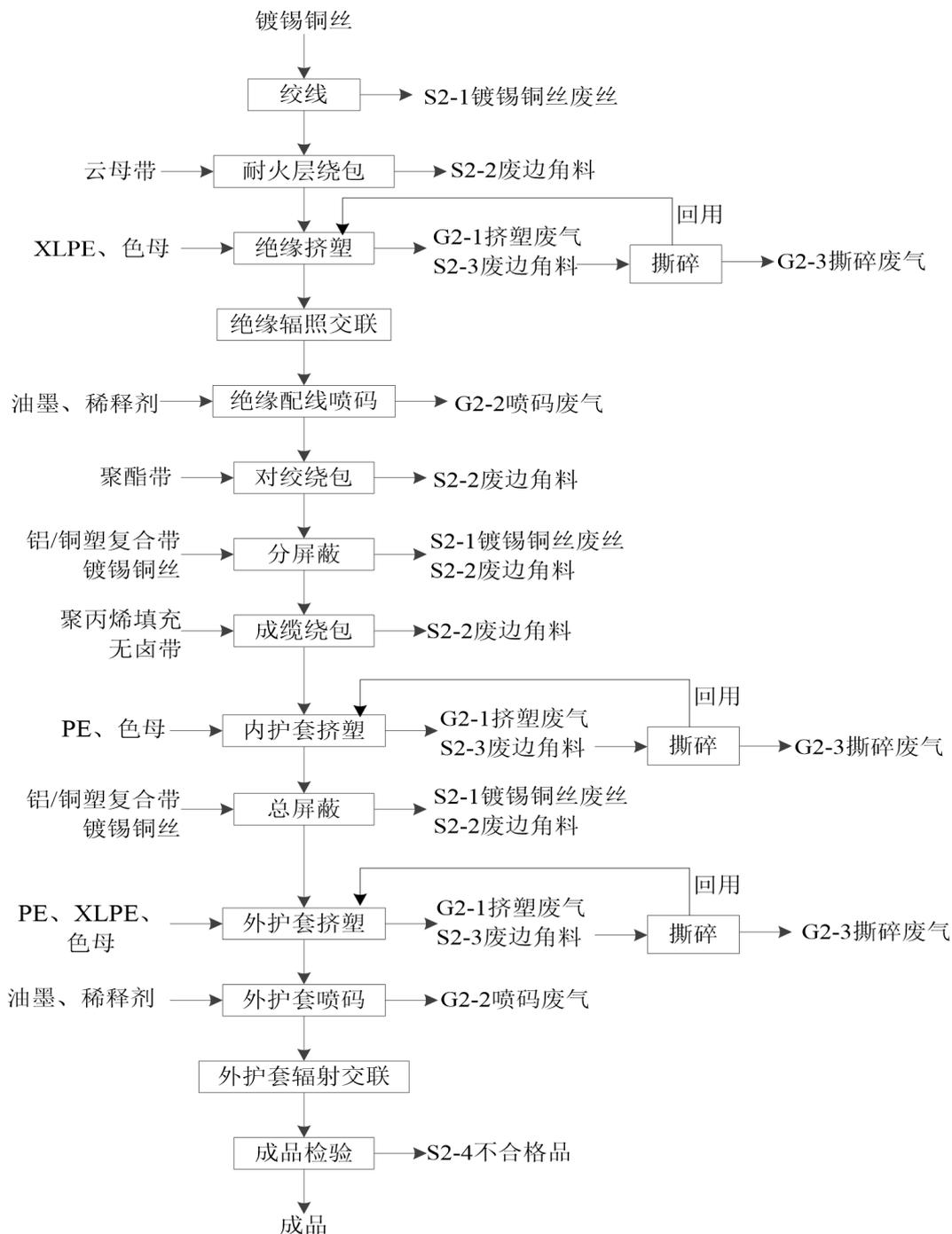
图2-5 舰船线缆生产工艺及研发工艺流程
