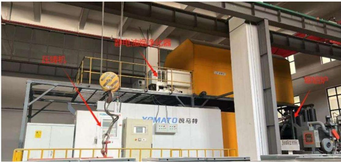
图 4-3 同款压铸设施废气收集及处理设施示意图
